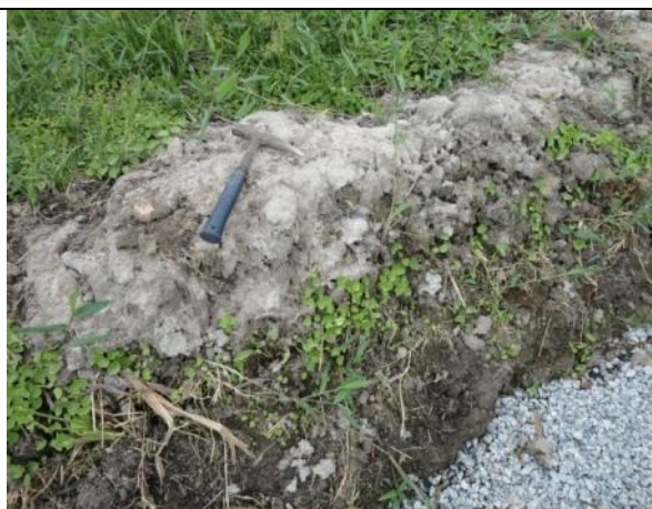
Foto V.3.4.3-19 - Vista de várzea interna na porção sudeste do TECAB. O local se encontra em obra com escavação e exposição de solos aluviais constituídos por areia média e grossa pouco argilosa, cinza-clara.
