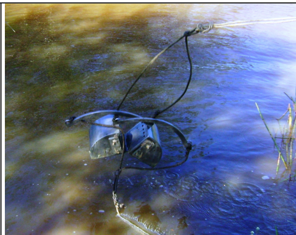
Foto V.3.9-6 - Lançamento da Draga do tipo Van Veen utilizada para coleta de amostras de sedimento e bentos – Ponto P4
