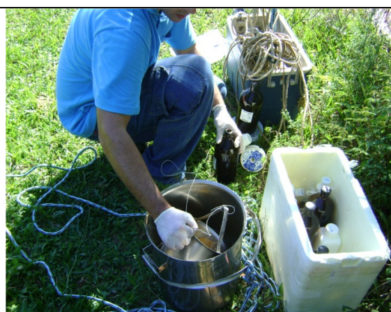
Foto V.3.10.1-14 - Coletor de aço inox utilizado para coleta de amostras de água superficial – Ponto P4
