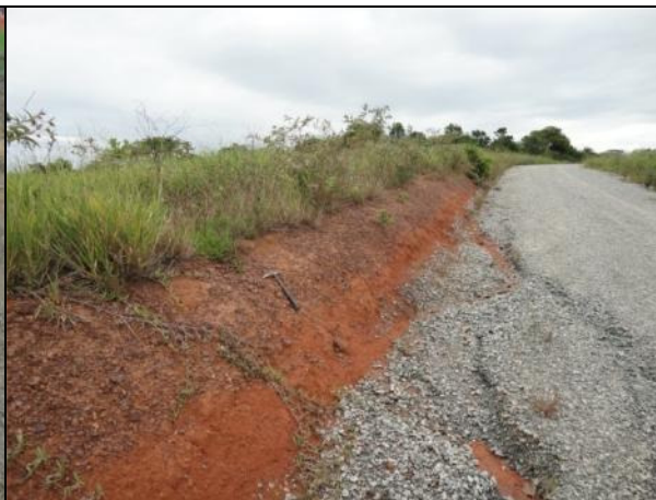
Foto V.3.4.3-16 - Porção noroeste da AID. Corte em colina na implantação de pista interna do TECAB. Ocorrência de linha de pedras associada ao colúvio depositado sobre as coberturas detríticas indiferenciadas e seus solos eluviais. A camada é constituída essencialmente por fragmentos de carapaças e de crostas lateríticas.
