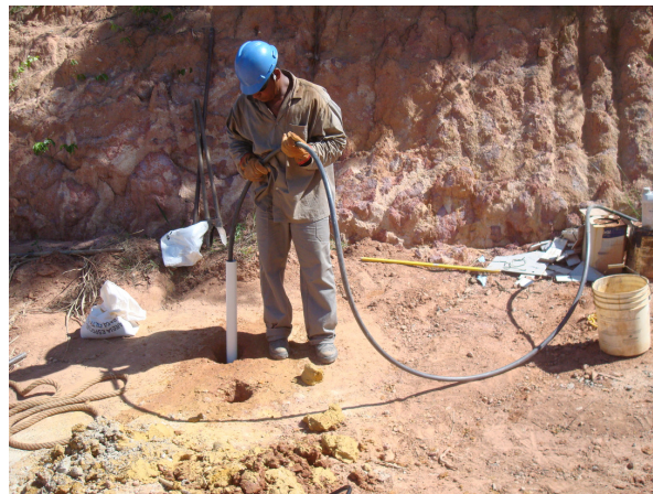
Foto V.3.8-2 - Sondagem para coleta de amostras de solo próximo a encosta.
